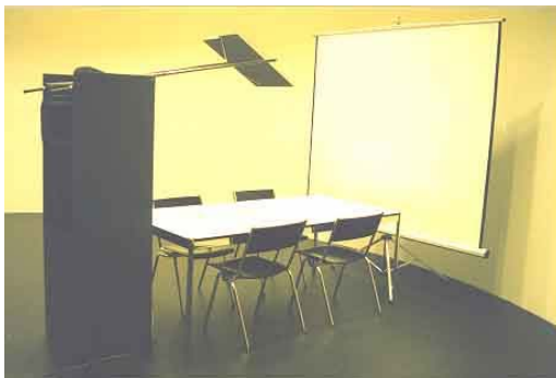
Abbildung 2: BUILD-IT System mit Spiegel, Tisch und Leinwand
