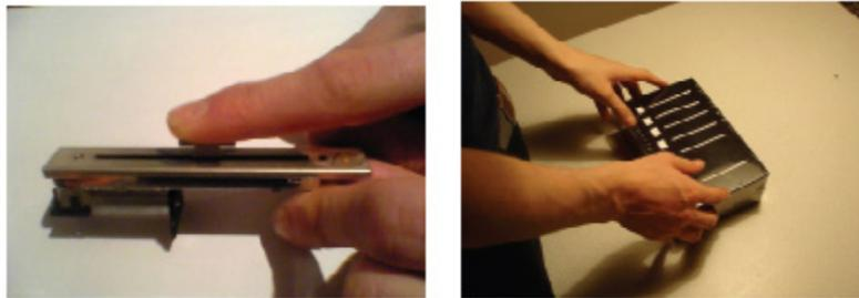
FIGURE 2.1: MOTORIZED SLIDER (LEFT) AND SLIDER BOX (RIGHT)
